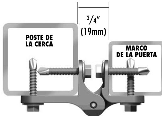
**OBSERVACIÓN:** Las bisagras Kwik-Fit están fabricadas para instalarse únicamente en los postes. Para la instalación en paredes donde no hay lugar para un poste para cerca, usar el modelo "Multi-Adjust" MFA.
